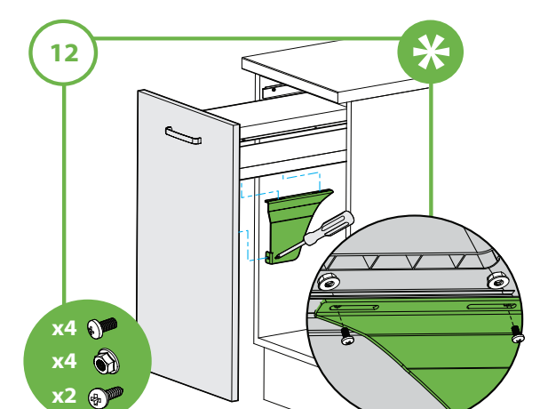
Attach door brackets if supplied/ Pokud jsou dodány, připevňte držáky dveří
